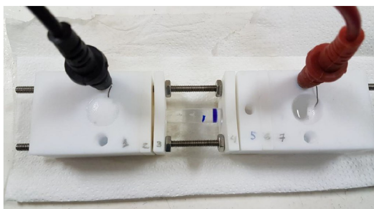
Figura 17. Foto de estrutura utilizada para realização de GELFrEE. As câmaras de carga são as próximas aos fios preto e vermelho, a câmara de coleta é indicada pelo número 5 e a frente de corrida é a linha em azul no tubo transparente.
